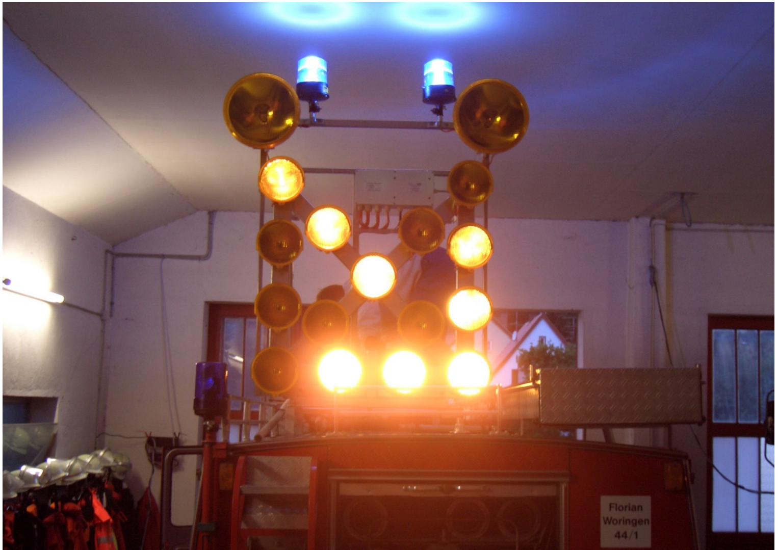
Umbau 2007: Das 44-1 erhält zur zusätzlichen Absicherung eine Verkehrswarnleuchte aufs Dach montiert.
