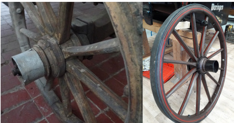
Eine Herausforderung der besonderen Art war es, die Speichen mit ihrer ursprünglichen Bemalung zu erhalten. Fingerspitzengefühl war gefragt, damit es wieder rund läuft.
